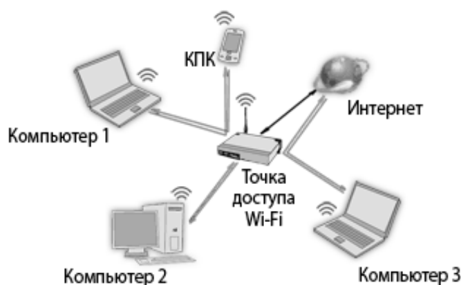
Рис. 1. Схема работы Wi-Fi маршрутизатора
