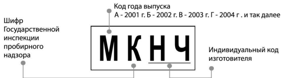
Рисунок 1 – Схема оттиска клейма изготовителя
