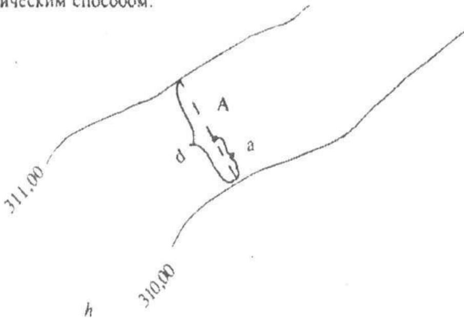
$$H_a = H_{\text{нир}} + d \cdot a \text{ (м);}$$
