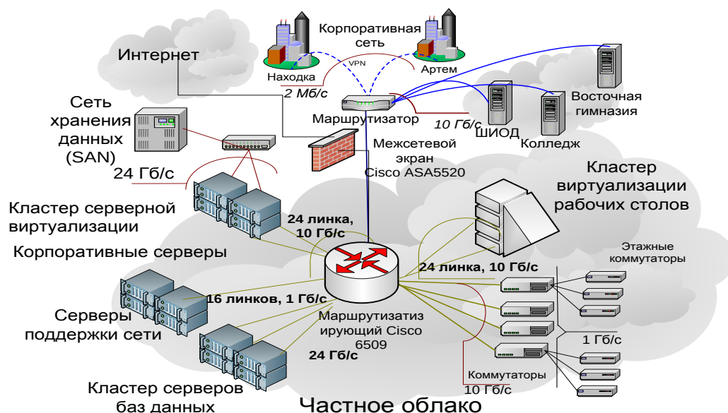
Рисунок 6.2 – Архитектура центра обработки данных Университета
